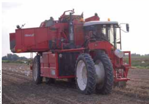
Automotriz de dos hileras con bunker
