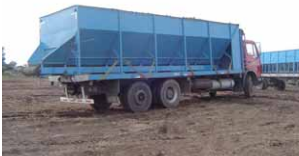
Camión con carro de trasporte de descarga automática. Purranque
