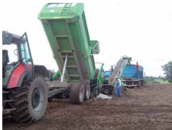
Descarga de remolque a tolva de recepción y cargado mediante cinta telescópica a camión, Purranque.
