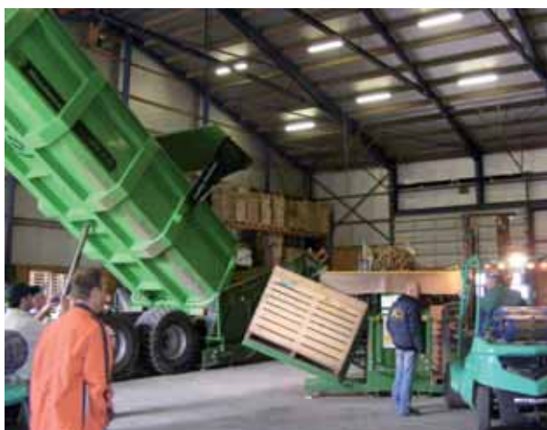
Descarga de remolque a tolva de recepción y conducción a cargador de bins en bodega. Holanda
