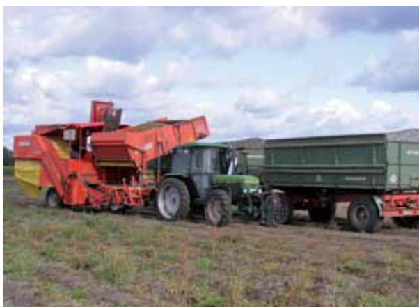
Cosechadora de arrastre de una hilera, con bunker acumulador
