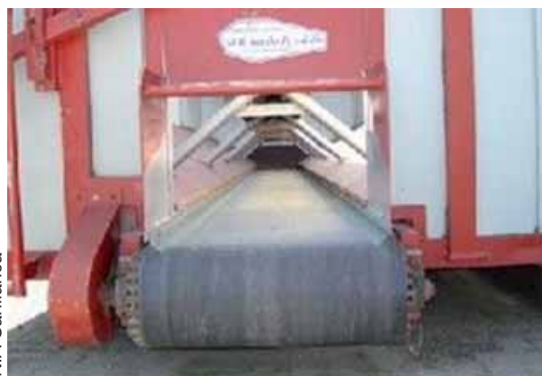
Base del vagón con sinfín de descarga accionado eléctricamente
