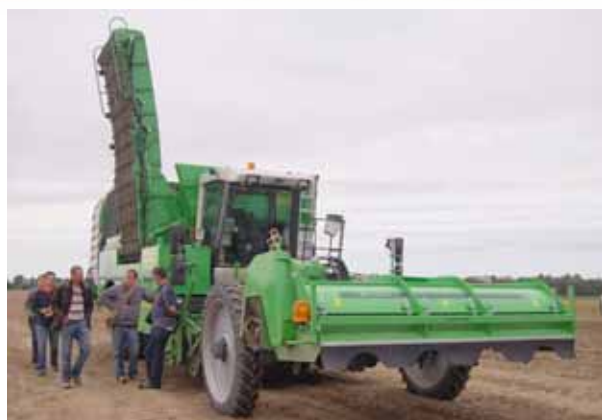
Automotriz de cuatro hileras con bunker
