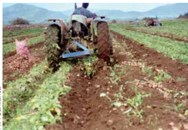
Arado partidor de melga para desenterrar las papas y recogerlas a mano. La Serena, Región de Coquimbo.
