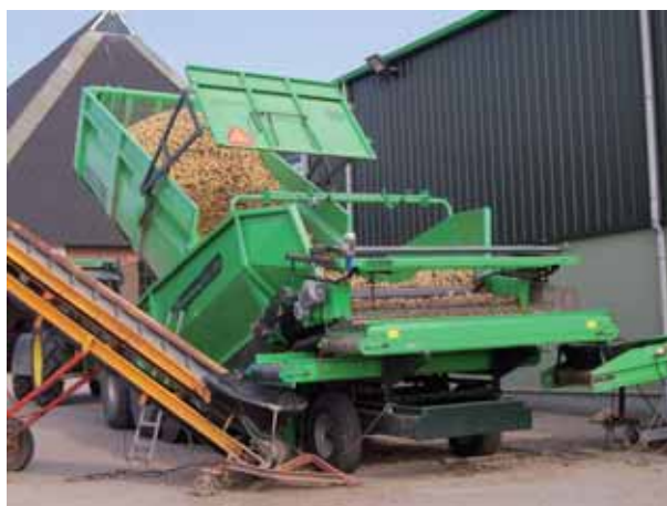
Descarga de remolque a tolva de recepción con pre-seleccionadora y desterronadora a entrada de bodega, Holanda.
