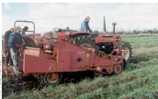
Máquina arrancadora y ensacadora de papa. Vilcún región de la Araucanía
